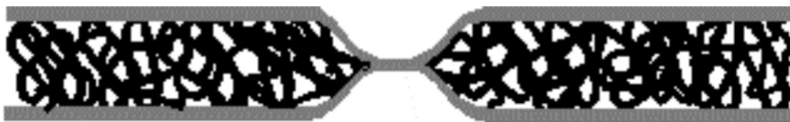
Abb. 3.2: Schematische Darstellung einer punktförmigen Verschweißung
