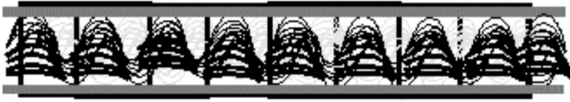
Abb. 3.3: Nahtverbindung bei einem gleichförmigen Gelege
